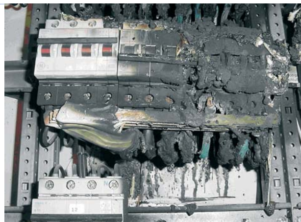
Het gevolg van thermische overbelasting van een type-goedgekeurde component in een verdeelkast.
